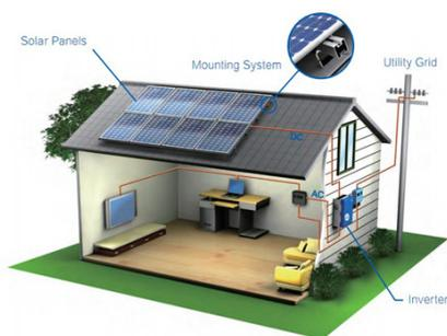
Ce kit de **10 KW** peut générer jusqu'à **40 KW par jour** (basé sur un ensoleillement maximal pendant 5 heures par jour) et stocker 48 KW dans ses batteries.
