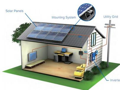
Ce kit de **8 KW** peut générer jusqu'à **32 KW par jour** (basé sur un ensoleillement maximal pendant 5 heures par jour) et stocker 38.4 KW dans ses batteries.
