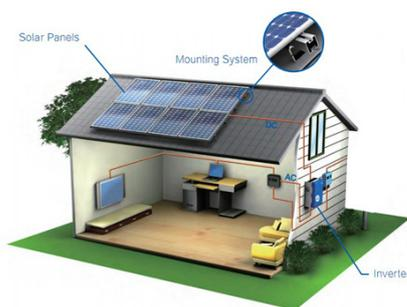
Ce kit de **4 KW** peut générer jusqu'à **16 KW par jour** (basé sur un ensoleillement maximal pendant 5 heures par jour) et stocker 9.6 KW dans ses batteries.
