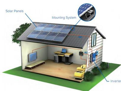
Ce kit de **1 KW** peut générer jusqu'à **4 KW par jour** (basé sur un ensoleillement maximal pendant 5 heures par jour) et stocker 4.8 KW dans ses batteries.
