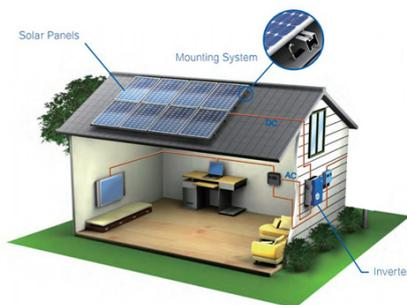
Ce kit de **3 KW** peut générer jusqu'à **12 KW par jour** (basé sur un ensoleillement maximal pendant 5 heures par jour) et stocker 9.6 KW dans ses batteries.
